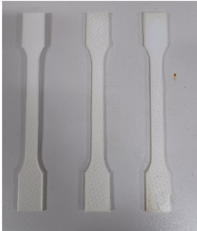
Figura 18 – Exemplo de corpos de prova impressos em 3D.
