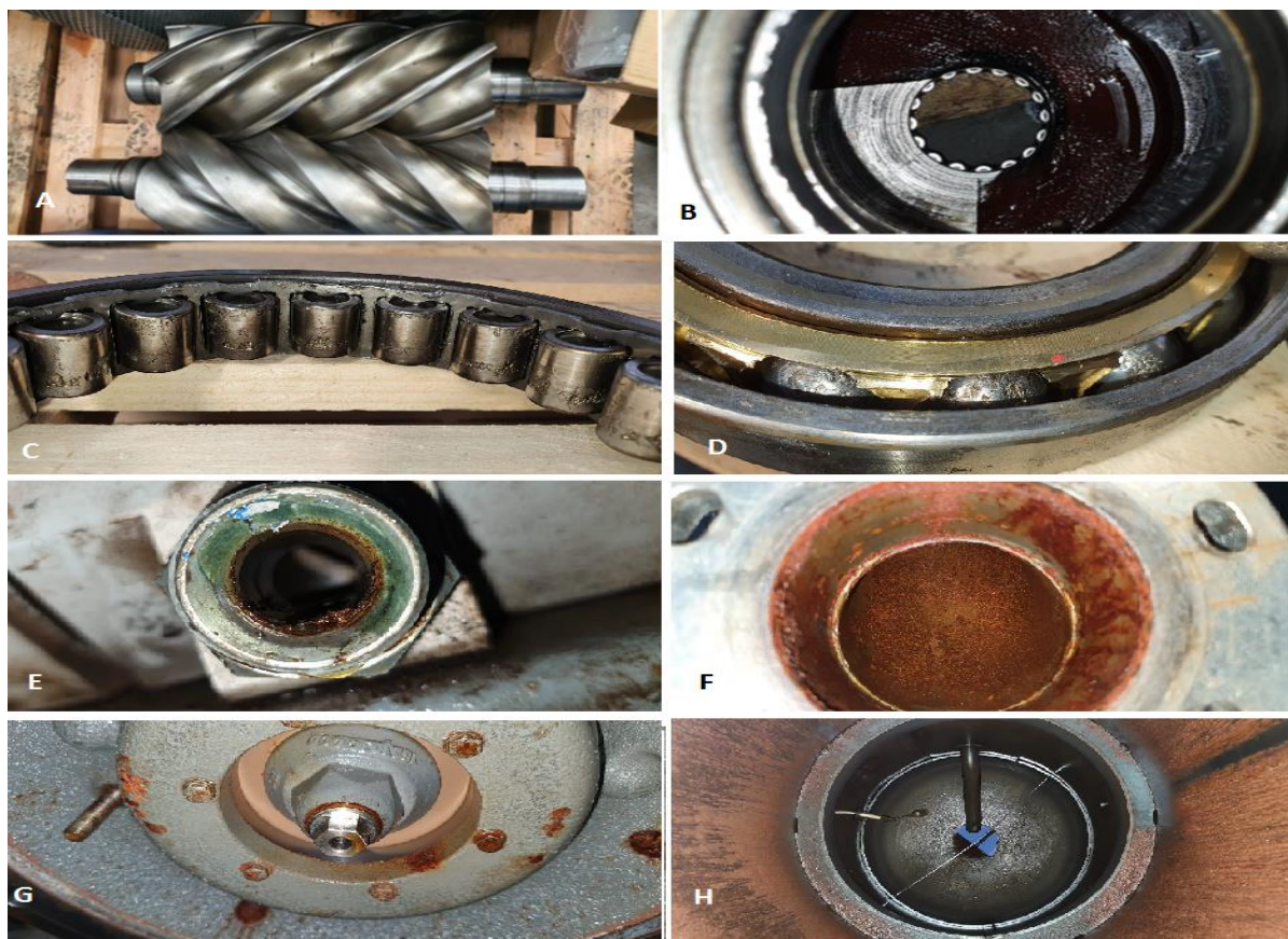
Figura 8 – Anormalidades na unidade compressora Atlas COPCO
