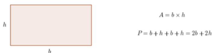
Figura 1: A figura ilustra um retângulo de dimensões b e h, com medida de área A = b \times h e de perímetro P = 2b + 2h .
