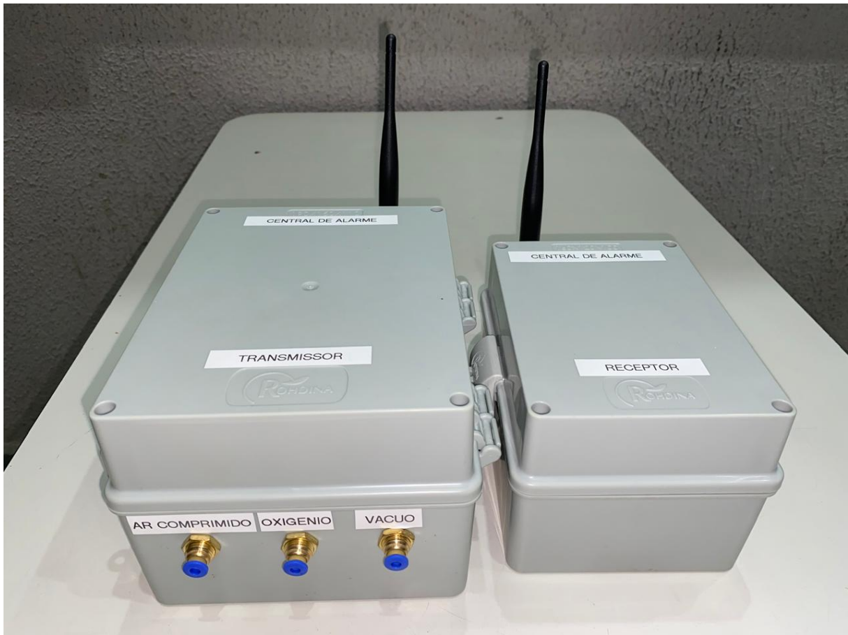
Figura 23 – Central de alarmes com módulos transmissor e receptor
