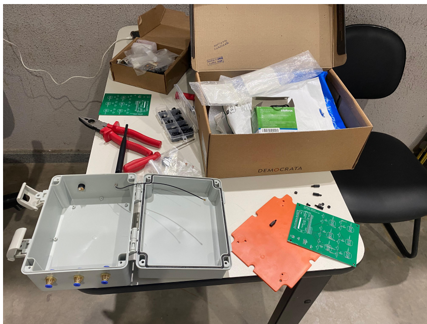
Figura 20 – Montagem final central de alarmes
