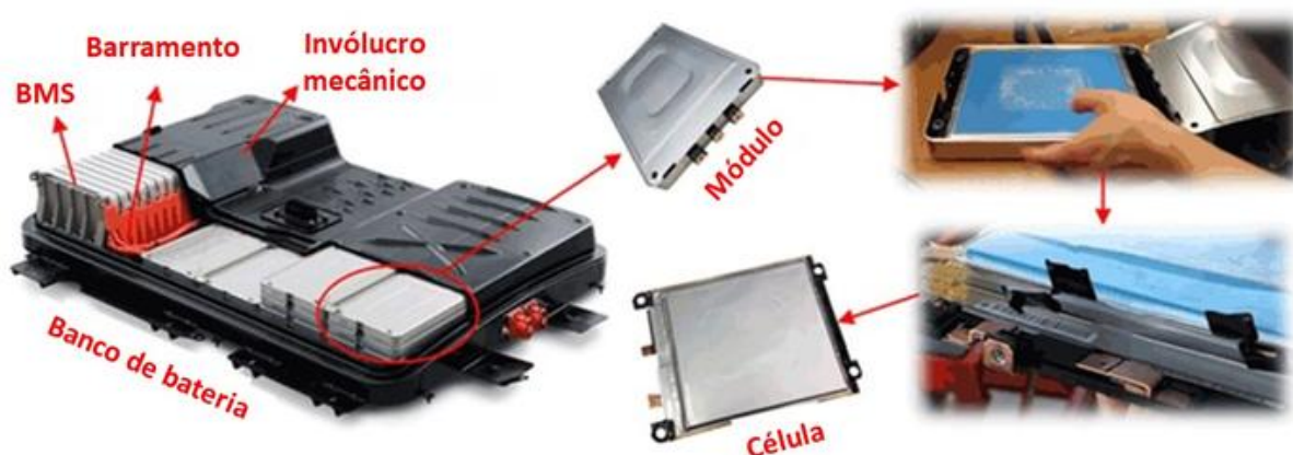
Figura 17 - Banco de bateria
