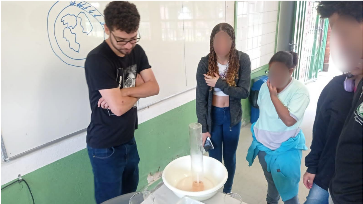
Figura 2: Experimento sobre diferença de pressão usando uma vela para criar “vácuo” no topo de um tubo fechado.
