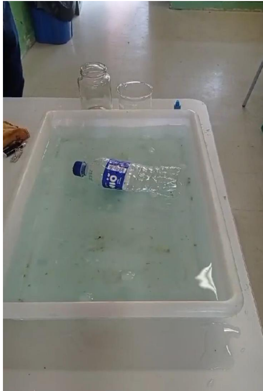
Figura 6: Diferença de pressão interna e externa esmagando uma garrafa de água. Simulação de uma implosão.
