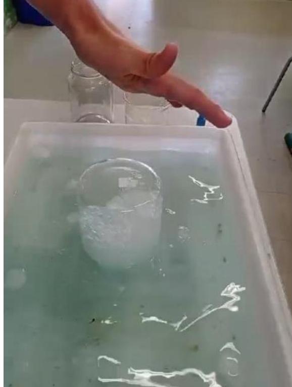
Figura 4: Experimento para mostrar que, quanto mais eficiente for o vácuo no interior do béquer (ou a diferença entre as pressões interna e externa), maior será a altura da coluna de água no mesmo.
