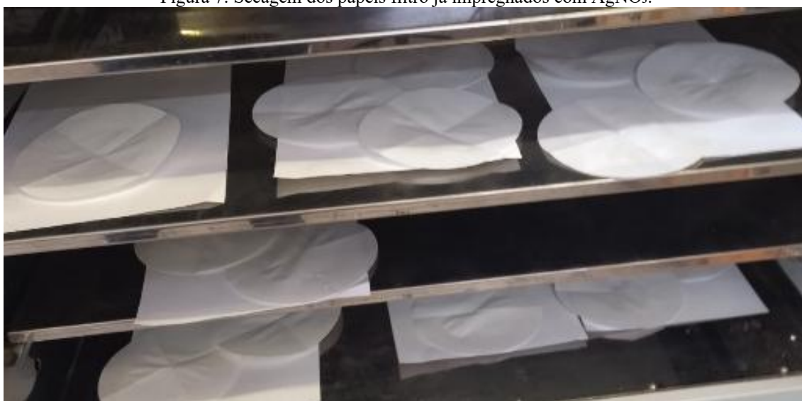
Figura 7: Secagem dos papéis filtro já impregnados com \text{AgNO}_3 .
