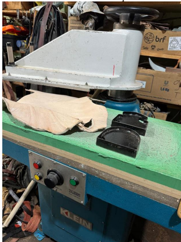
Figura 15 - Processo de corte com utilização do Balancim Hidráulico
