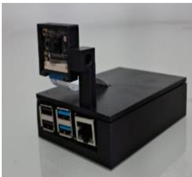
Figura 11 – Hardware (câmera e raspberry montados na case)
