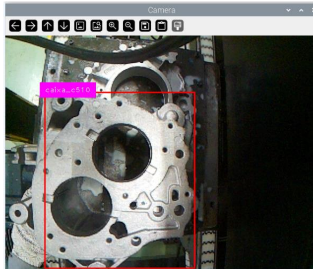
Figura 16 – Teste do sistema do sistema de visão sem falhas.
