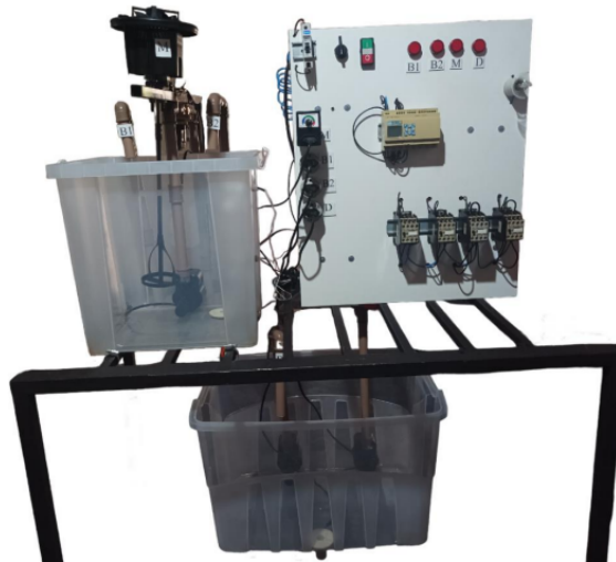
Figura 3 – Bancada Didática para o ensino de automação industrial em sala de aula.
