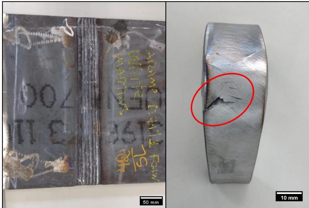
Figura 16 – Chapas com Processo de Soldagem sem Limpeza de Raiz e Junta Soldada com Trinca
