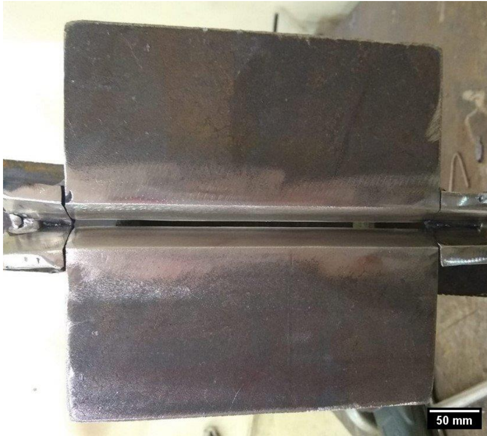
Figura 10 – Posicionamento das Chapas para Soldagem
