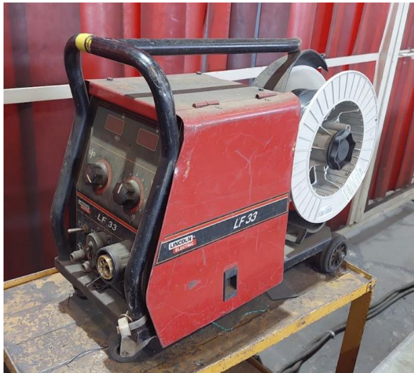
Figura 6 - Cabeçote de Alimentação Utilizado na Soldagem das Chapas
