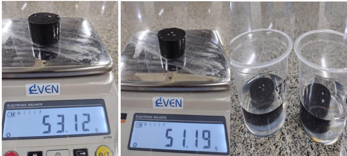
Figura 38 - Briquetes de carvão e silicato de sódio, com 5 e 7% de ligante, após absorção de água de 30 minutos.
