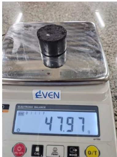
Figura 39 - Pesagem após secagem em estufa a 100°C
