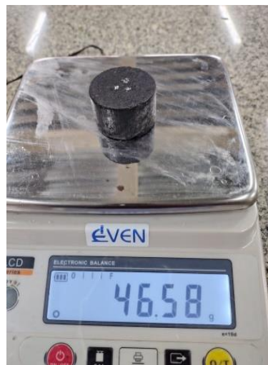
Figura 39 - Pesagem após secagem em estufa a 100°C
