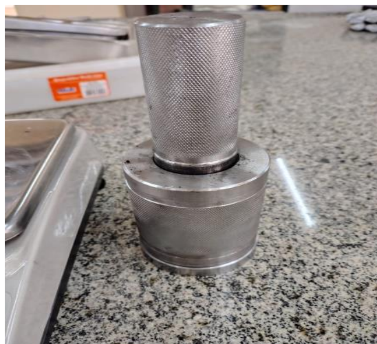
Figura 30 - Molde Pronto para Prensagem Figura 31 - Molde na Prensa
