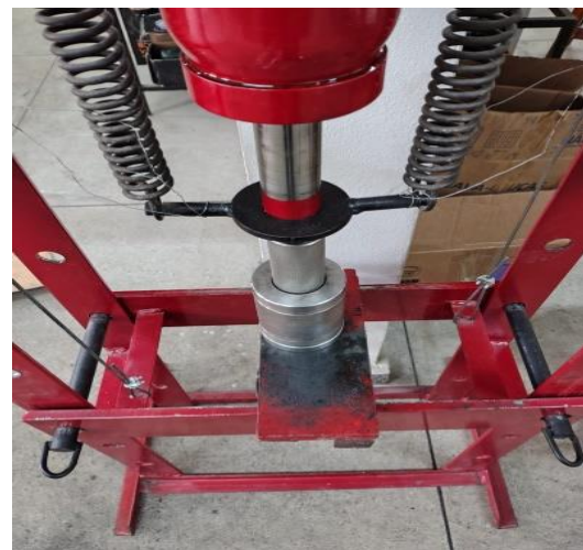
Figura 30 - Molde Pronto para Prensagem Figura 31 - Molde na Prensa
