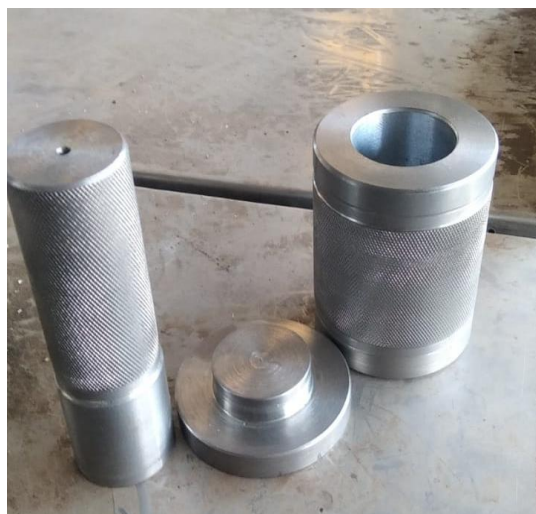
Figura 27 - Molde para Corpos de Prova
