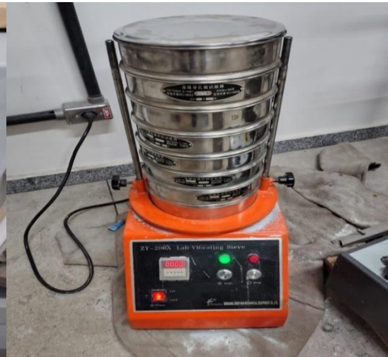
Figura 25 - Estação de Peneiramento
