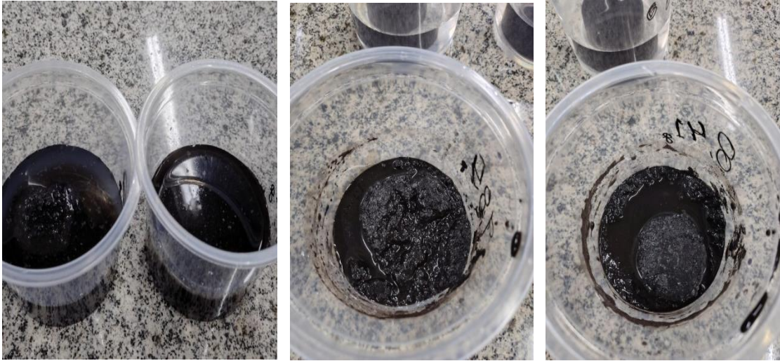
Figura 40 - Briquetes de carvão e melaço com 5 e 7% de ligante, após absorção de água durante 30 minutos.
