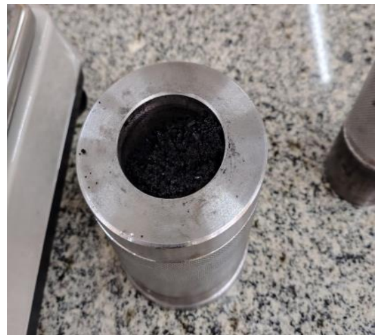
Figura 29 - Preenchimento do Molde
