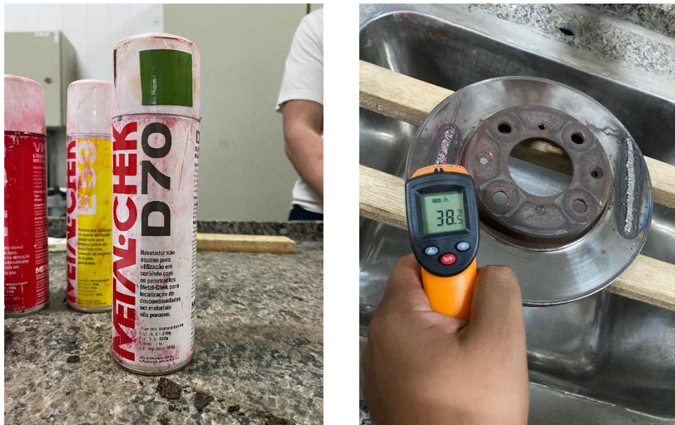
Figura 20. Revelador D70 e Temperatura pós soldagem
