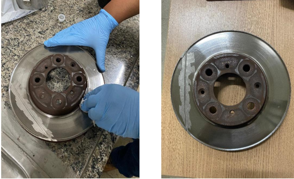
Figura 13. Disco em processo de limpeza
