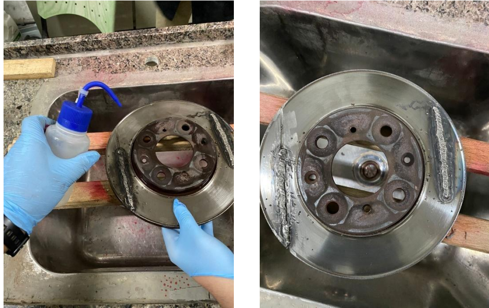
Figura 23. Remoção do LP e secagem da peça
