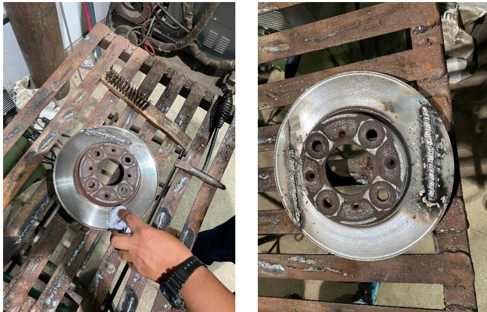
Figura 17. Limpeza da superfície e 2º cordão de solda
