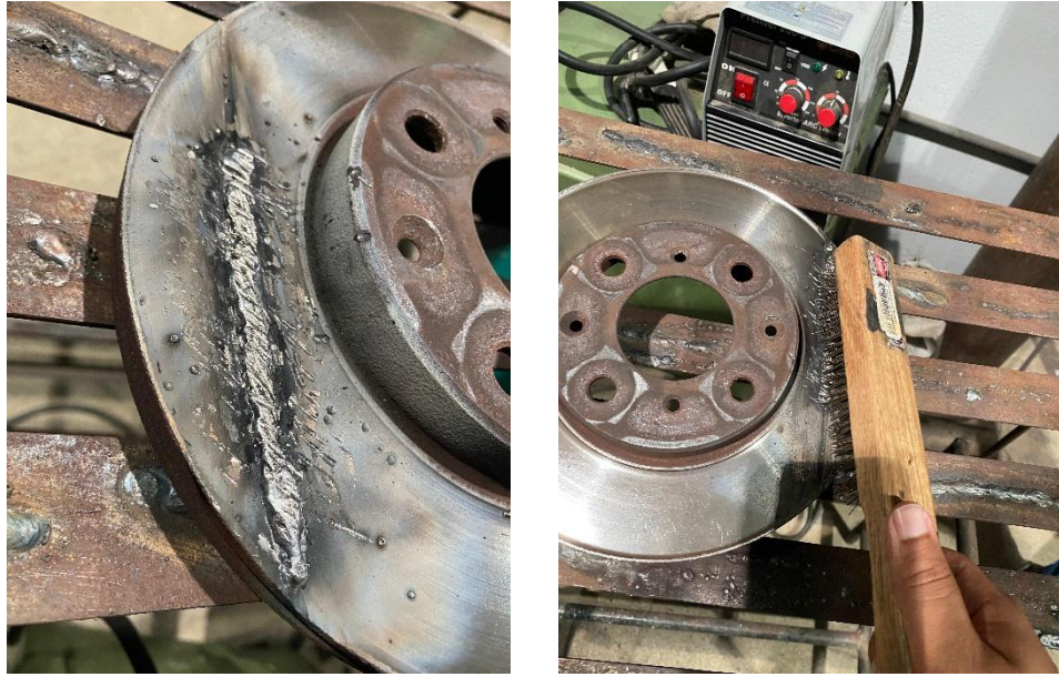
Figura 15. Martelamento do cordão e escovamento
