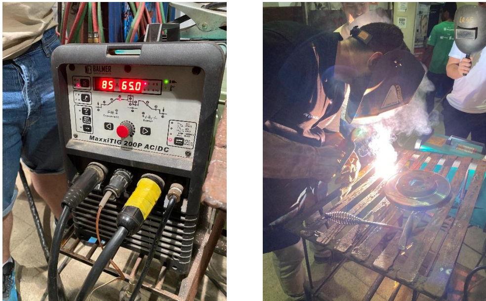
Figura 14. Inversora regulada em 85A e soldagem em processo
