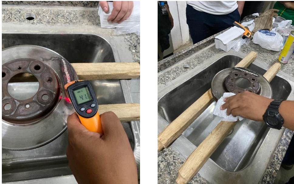
Figura 21. Temperatura pós soldagem e limpeza para o END de LP
