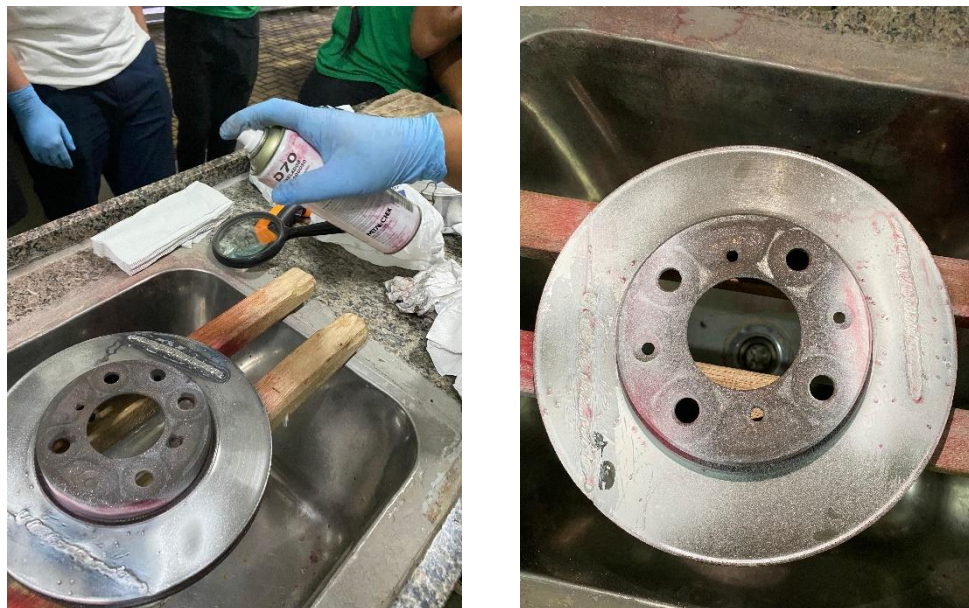
Figura 24. Aplicação do revelador D70 e Peça para realizar análise
