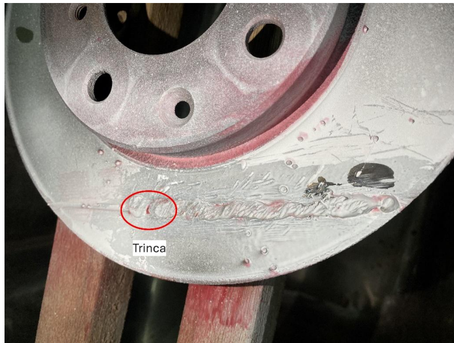
Figura 30.Descontinuidade encontrada no ensaio por LP do cordão B
