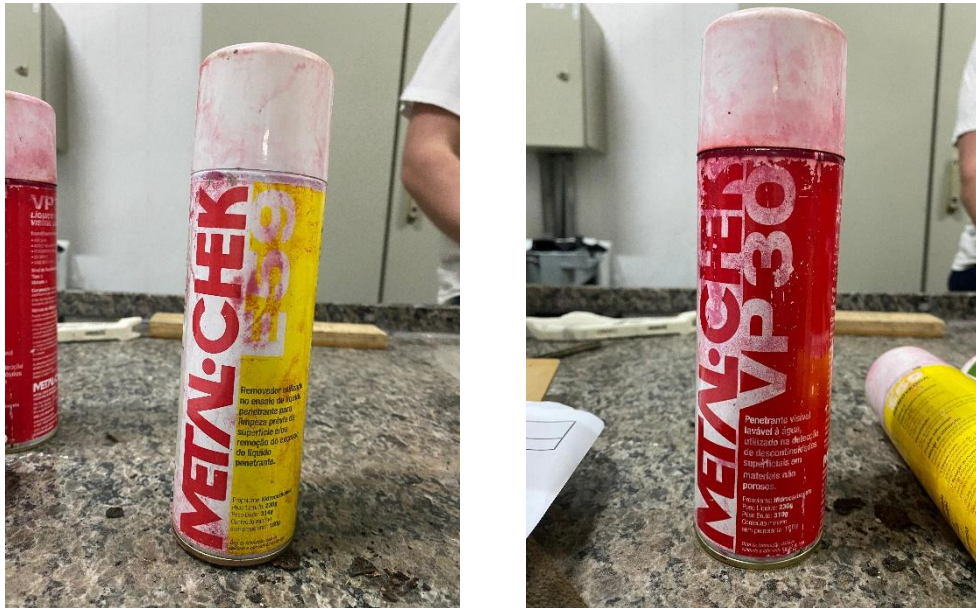
Figura 19. Removedor E59 e Líquido penetrante VP30
