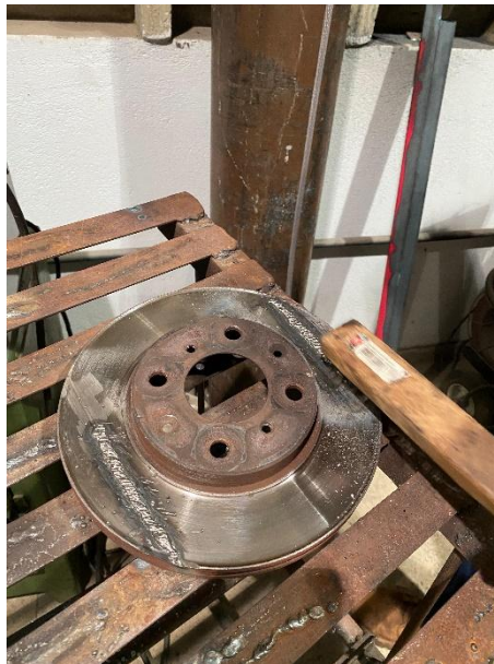
Figura 18. Limpeza com escova de aço
