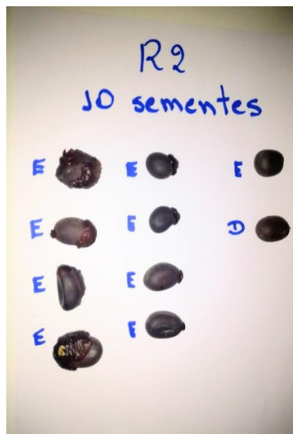
Figura 8 – Sementes de Jatobá escarificadas no protótipo e após o teste de embebição. As sementes acompanhadas das letra E embeberam água e as acompanhadas da letra D permanecem duras.
