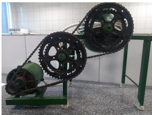
Figura 5 - Visão das catracas ligadas ao motor
