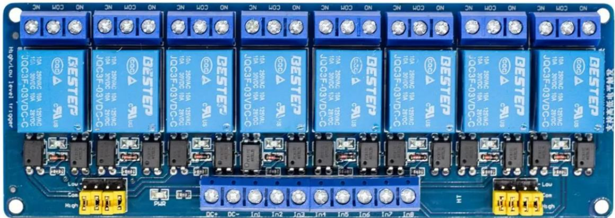
Figura 6 – Módulo de relés com isolamento de optoacopladores.
