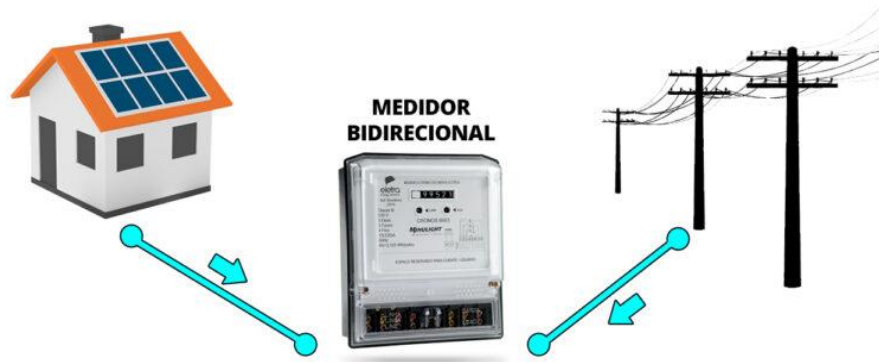
Figura 6: Funcionamento do medidor bidirecional de energia elétrica.
