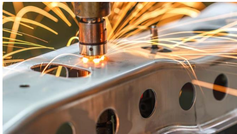
Figura 07 – Solda à projeção em indústria automotiva.
