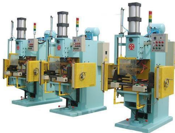
Figura 05 – Máquinas de solda à projeção em adequação a NR12.
