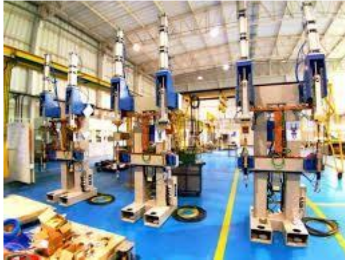
Figura 01 – Linha de máquinas de solda à projeção estacionárias.
