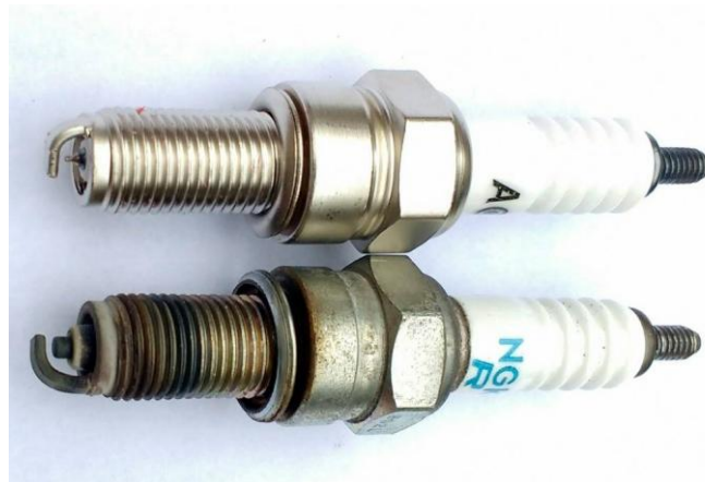
Figura 28 – Comparativo das velas de ignição em irídio e convencionais com eletrodo de cobre.
