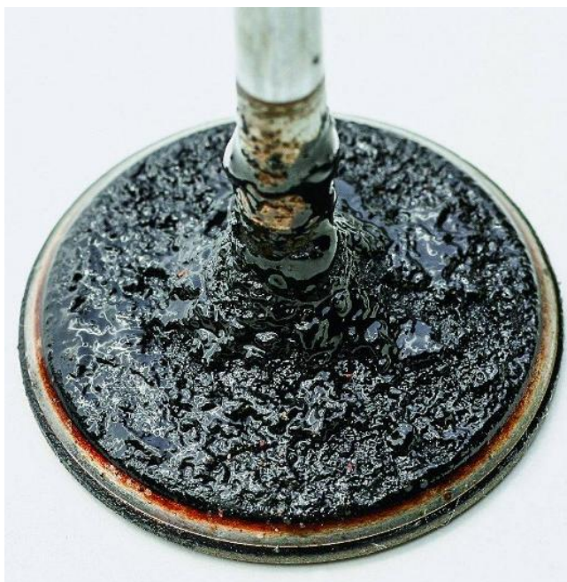
Figura 34 – Carbonização das válvulas de admissão do motor 1.0 TSI.
