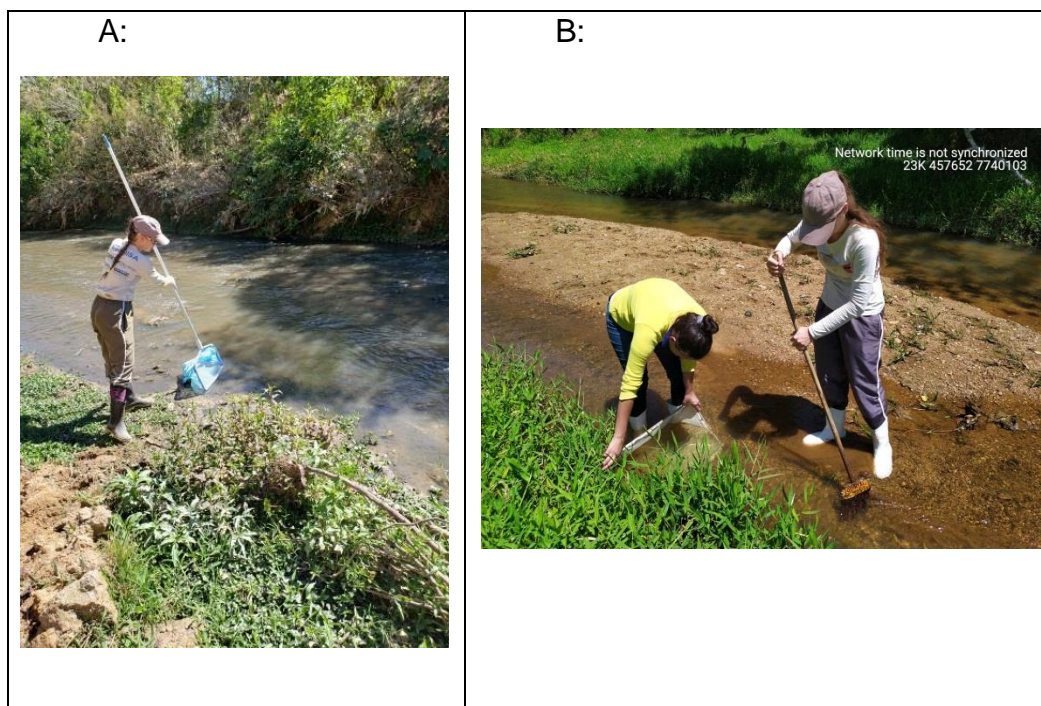
Figura 2- A- Amostrador tipo suber e B- Rede de amostragem realizando a varredura
