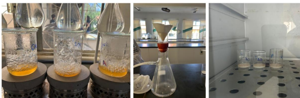
Figura 7 - Etapas da análise de fibra bruta no laboratório de bromatologia do IFMG – Campus Bambuí (da esquerda para a direita): (1) Amostra previamente pesada em béquer, com solução de ácido sulfúrico a 1,25%, sendo fervida por 30 minutos em chapa elétrica com agitação constante; (2) Filtragem dos resíduos utilizando kitasso com alonga, bomba de vácuo, cadinho sinterizado, funil e peneira, seguida de lavagem com água quente e álcool etílico; (3) Cadinhos contendo os resíduos acondicionados em estufa por 3 horas.
