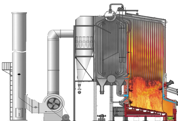
Figura 5.7 – Caldeira do tipo aquatubular
