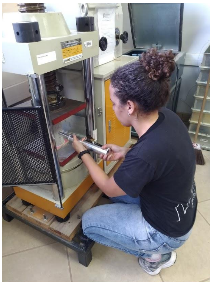
Figura 10 - Realização do ensaio esclerométrico, por meio da compressão axial.
