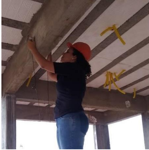
Figura 16 - Realização do ensaio ultrassônico na viga 2.
