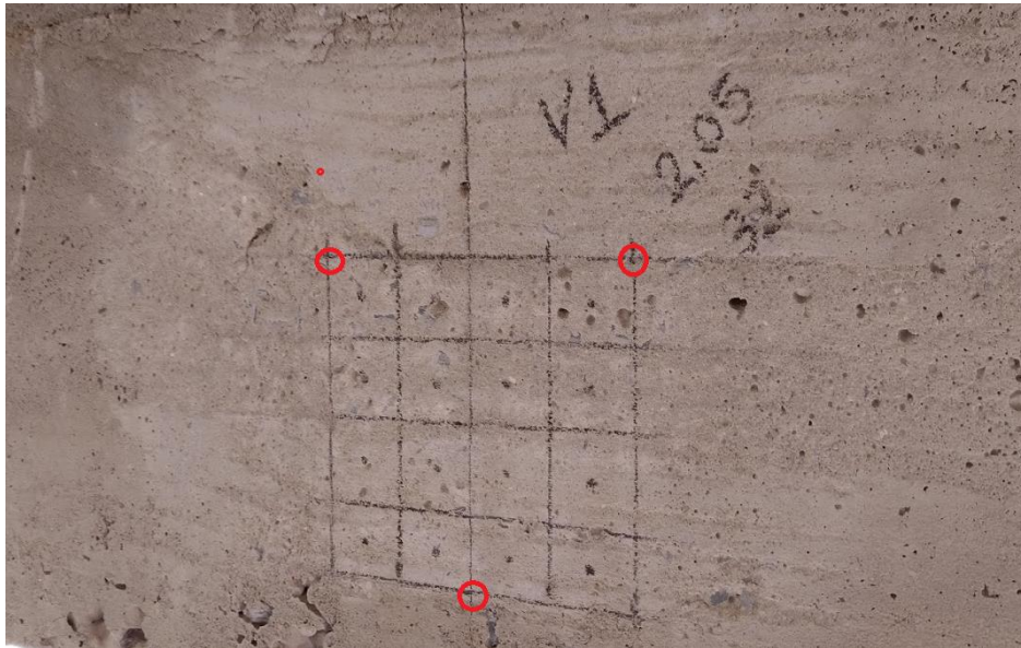
Figura 15 - Localização dos pontos ensaiados no método ultrassônico.
