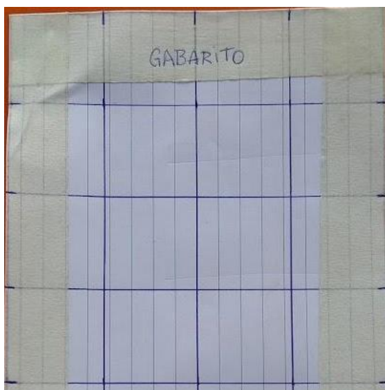
Figura 12 - Gabarito para demarcação da área a ser ensaiada.
