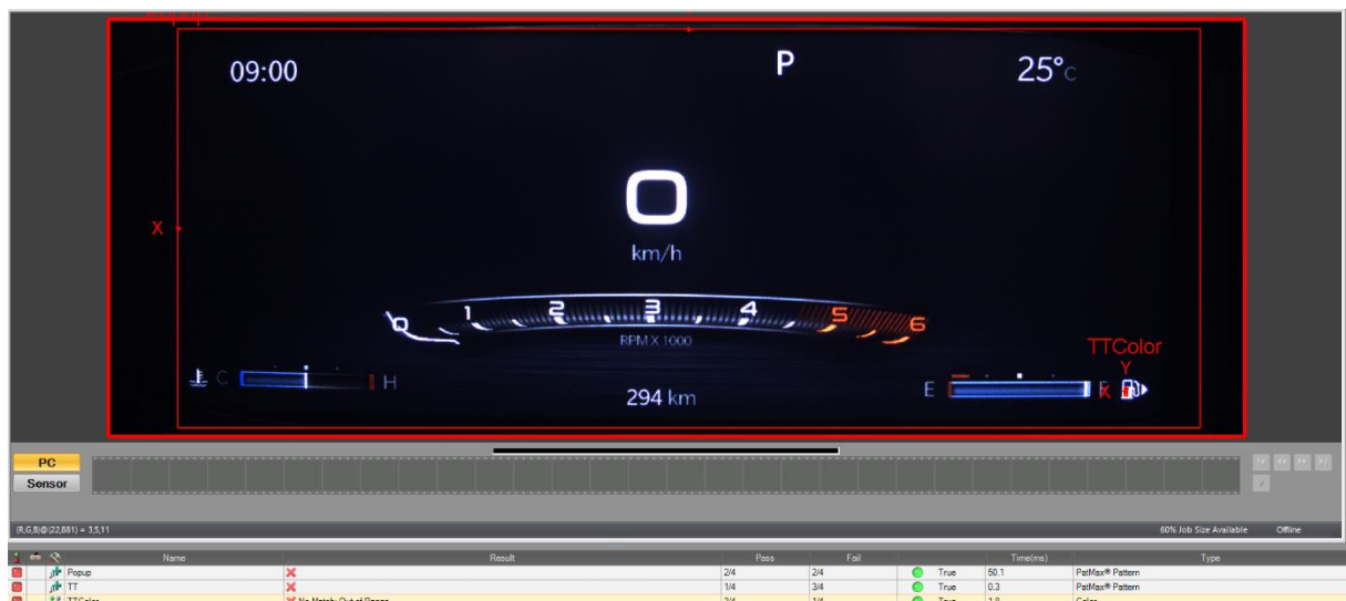
Figura 35: Teste para verificar se há diferenciação entre branco e o amarelo treinado
