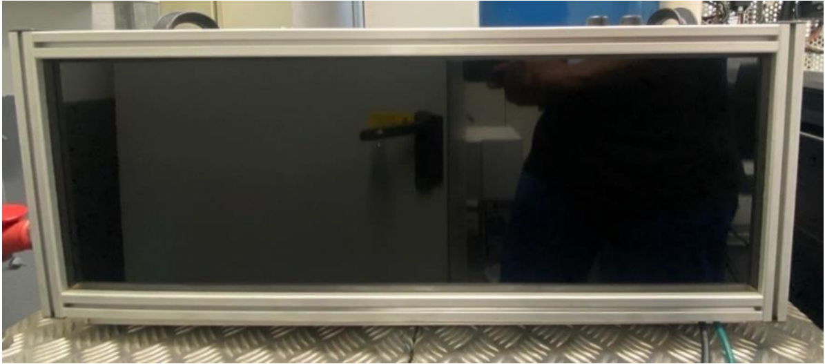
Figura 18: Caixa projetada para reduzir o efeito da iluminação externa
