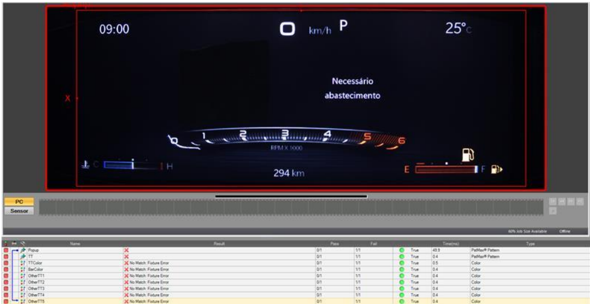
Figura 31: Ausência da imagem da bomba de combustível
