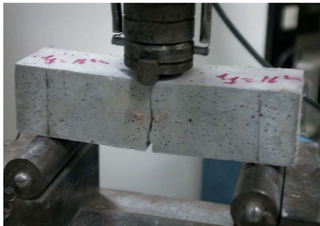
Figura 7: Ensaio de tração na flexão
