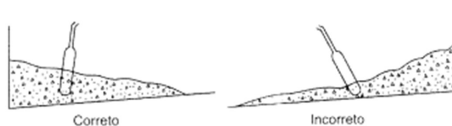
Figura 4: Adensamento do concreto com vibrador de imersão
