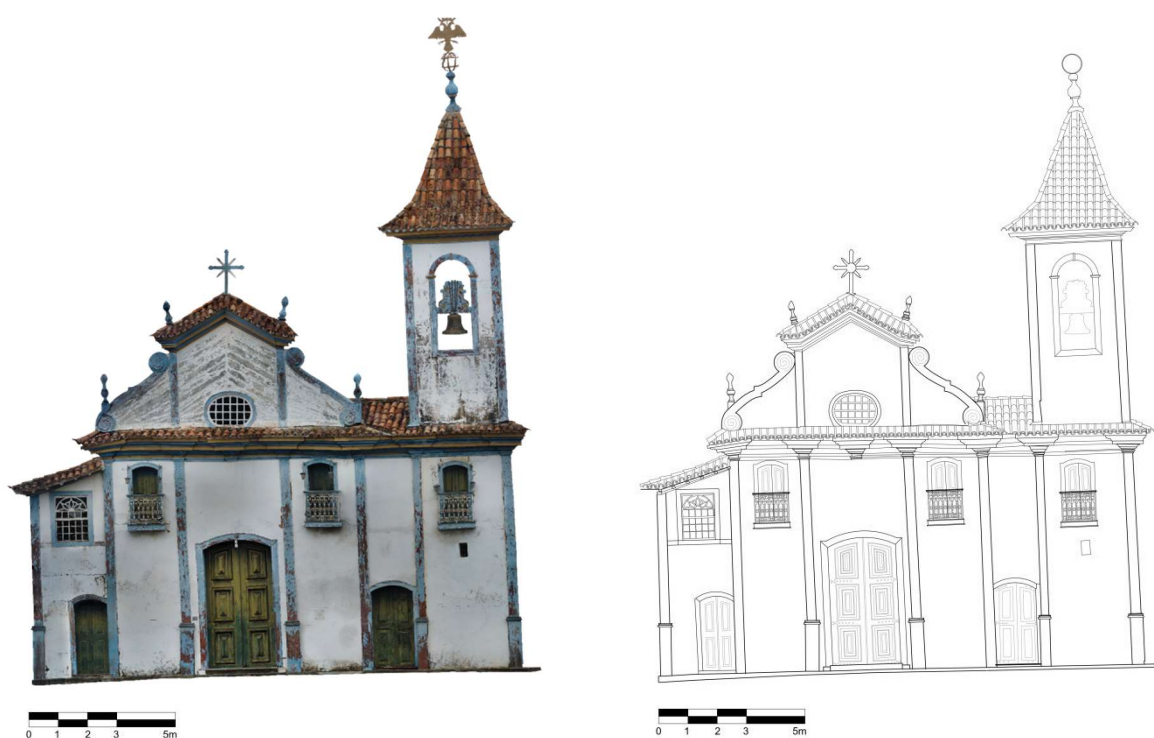
FIGURA 58 – Ortofoto (esquerda) e desenho técnico (direita) da fachada noroeste. Fonte: Autor, 2025.
