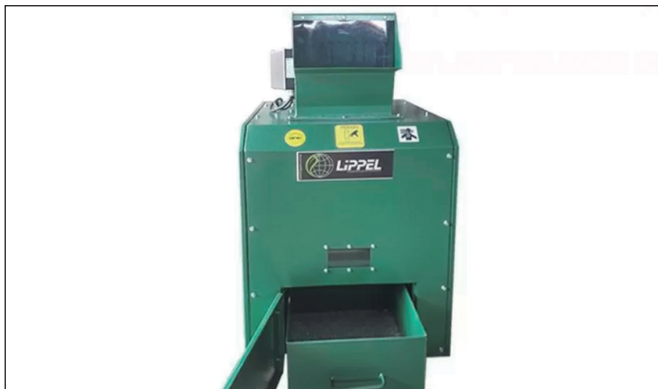
Figura 4 – Máquina para lavagem e esterilização de embalagens
