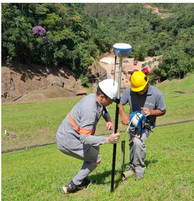
Figura 4 – Exemplo de uma leitura da profundidade de um piezômetro sendo realizada.
