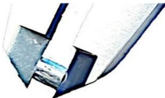
Figura 13 Imagem de como medir espessura da parede das anilhas.
