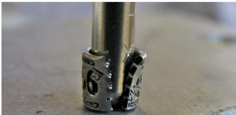
Figura 20 Figura mostrando o lacre de segurança de uma anilha SISPASS se rompendo com uma pressão superior ao diâmetro interno deste anel. Fonte: http://trincaferroverdadeiro.blogspot.com/2012/09/tentativa-de-dilatacao-da-nova-anilha.html
