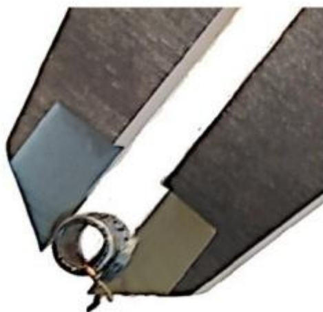
Figura 11 Imagem de como medir o diâmetro externo das anilhas.
