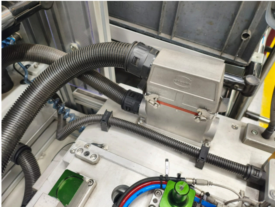
FIGURA 41 - Tomada de interface dispositivo com a bancada
