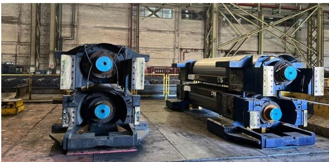
Figura 5 - Conjunto de cilindros de trabalho de um Laminador Steckel .
