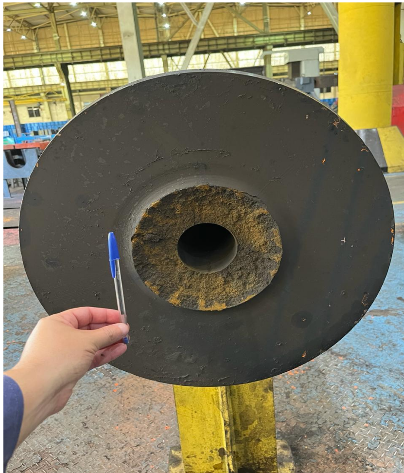
Figura 15 - Ponta de eixo quebrada do Pinch Roll Inferior.
