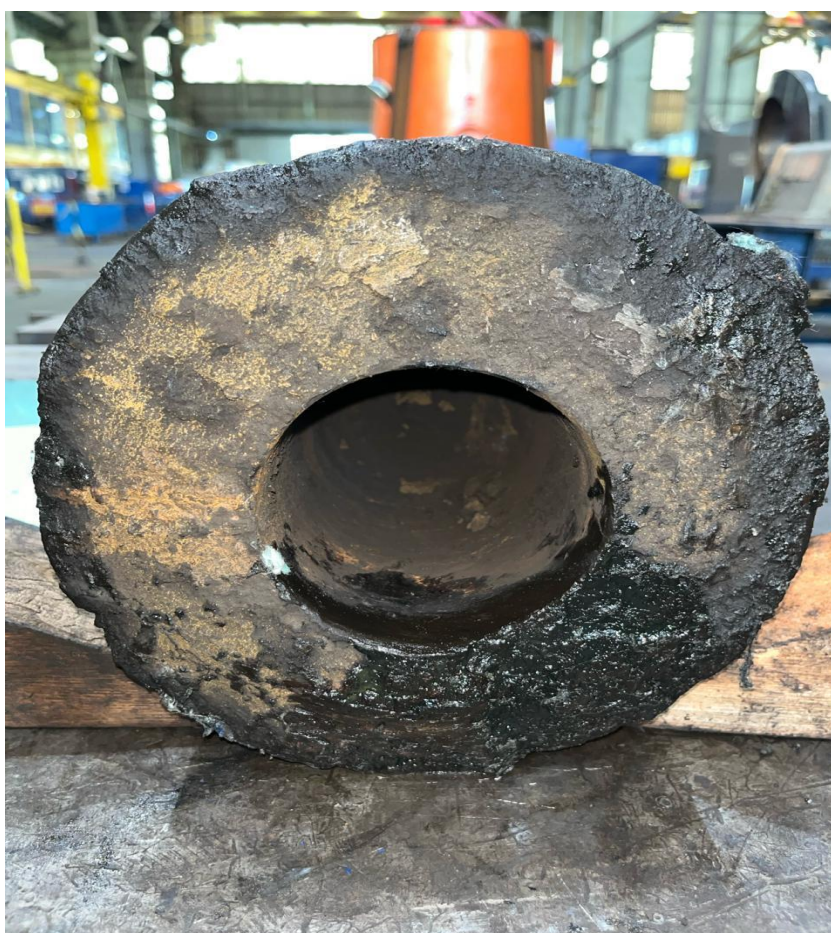
Figura 12 - Fratura por fadiga de um Pinch Roll Inferior.
