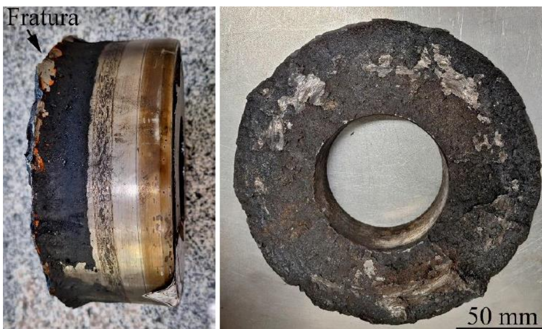
Figura 16 - Amostra da ponta de eixo do Pinch Roll analisada.
