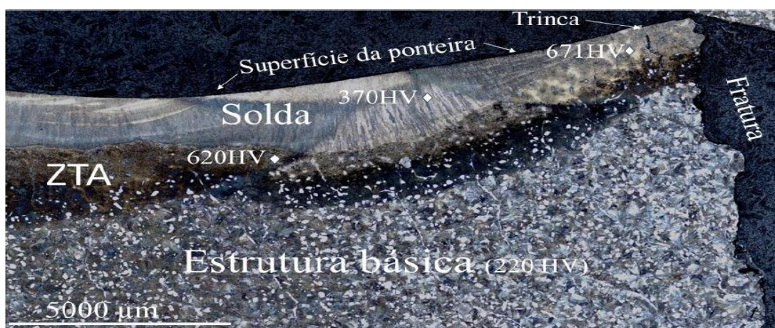
Figura 24 - Estrutura da seção longitudinal em região de início da ruptura (mesma região das fig. anteriores), mostrando trincas próximas a ruptura e indicações de valores de dureza.
