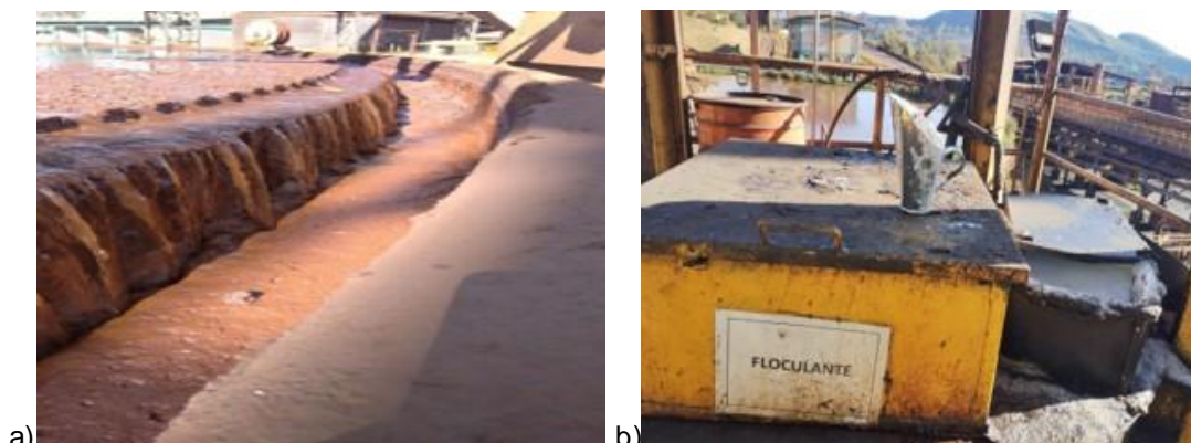
Figura 12 - (a) espessador com alta turbidez, (b) processo manual de dosagem de floculante
