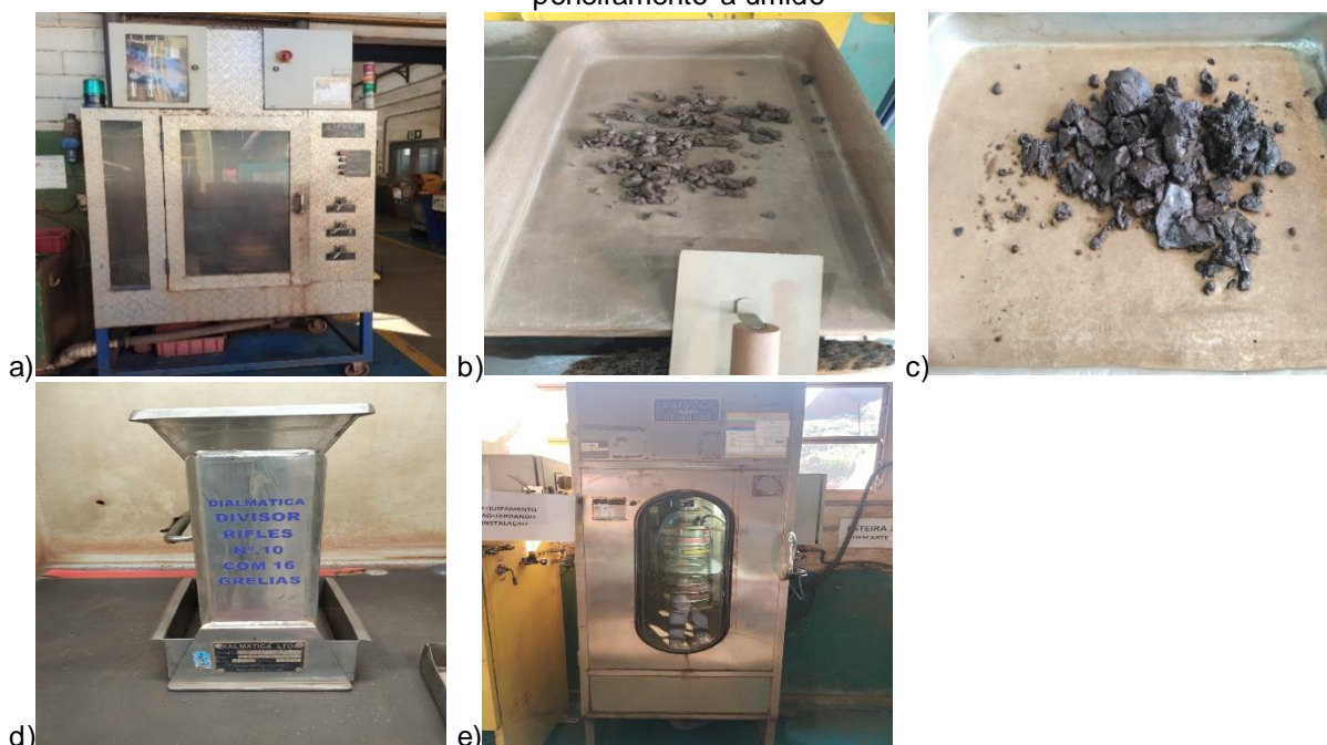
Figura 16 - Equipamentos e processos utilizados na análise granulométrica. (a) filtro prensa, (b) processo de secagem da amostra, (c) amostra úmida na chapa térmica, (d) divisor rifles e (e) peneiramento a úmido
