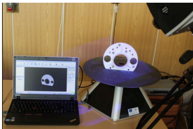
Imagem 1 – Scanner Steinbichler Comet L3D durante o processo de digitalização
