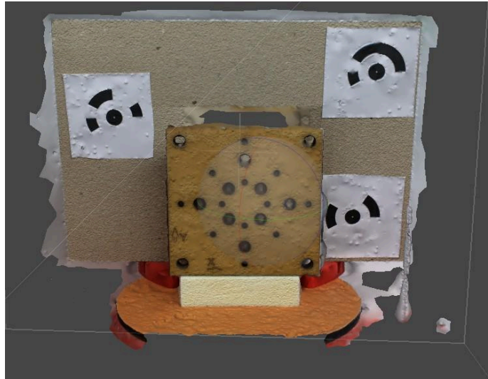
Figura 7 – Malha poligonal densa reconstruída, evidenciando a topologia dos furos antes da correção de escala.
