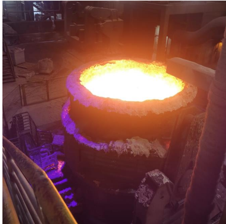
Figura 5.4 Estação de Tratamento do Forno Panela Após Espumação.
