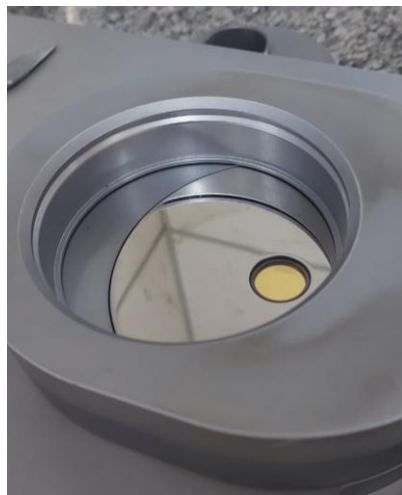
Figura 18: Célula de amostra, com fundo de quartzo transparente.
