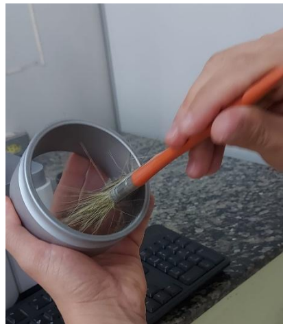
Figura 20: Limpeza da célula de amostra com o auxílio de um pincel.
