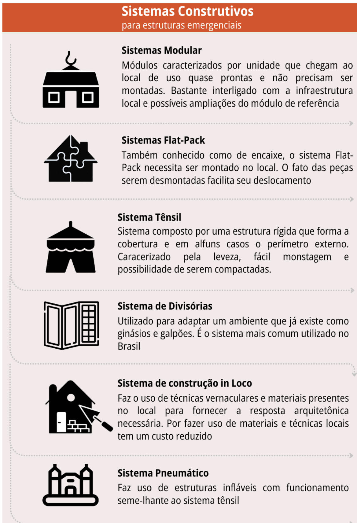
Figura 16: Sistemas construtivos para estruturas emergenciais
