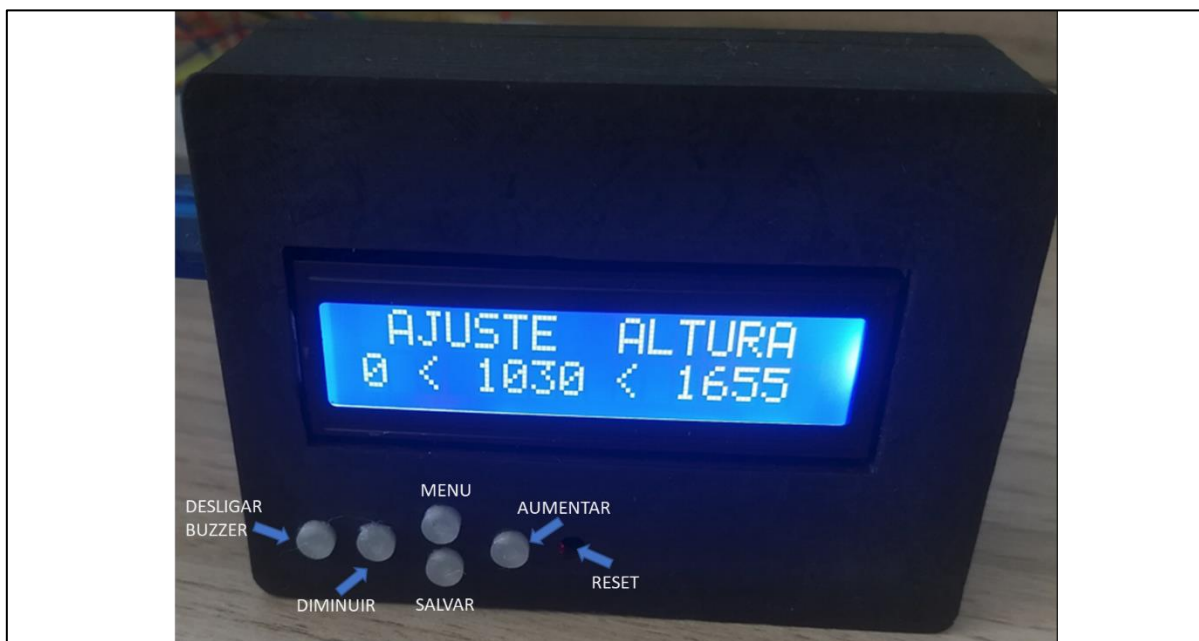
Figura 15 - Shield LCD acoplado na caixa com identificação dos botões.
