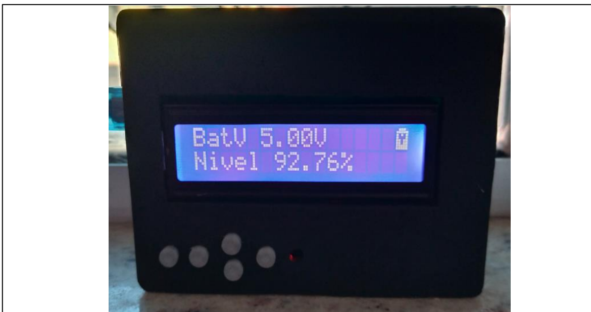
Figura 16 - Tela com informações da bateria e nível do reservatório
