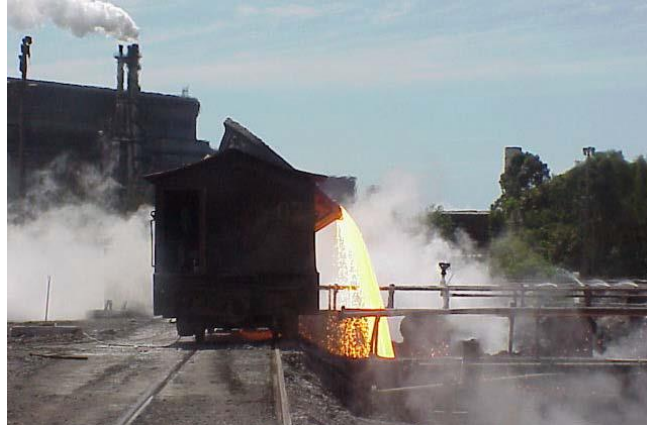
Figura 11 - Basculamento da escória de aciaria.
