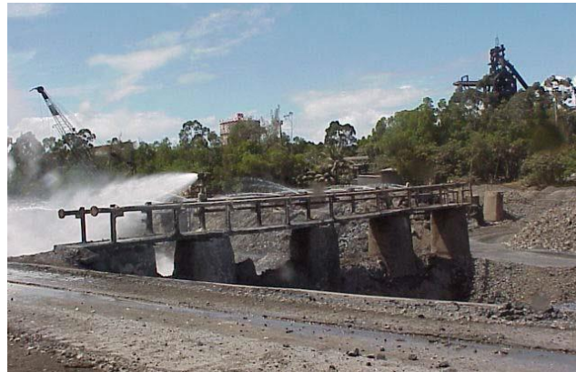
Figura 12 - Resfriamento da escória de aciaria.
