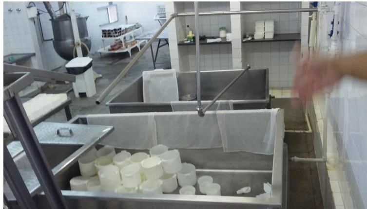
Figura 33: Tanques de parede dupla para pasteurização (não estava produzindo na hora).
