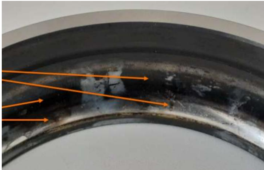
Figura 14 – Evidências de desgaste na pista externa do rolamento externo.
