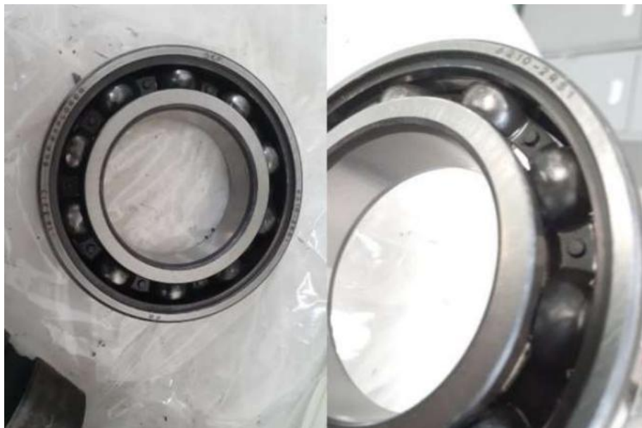
Figura 16 – Evidências do rolamento radial.
