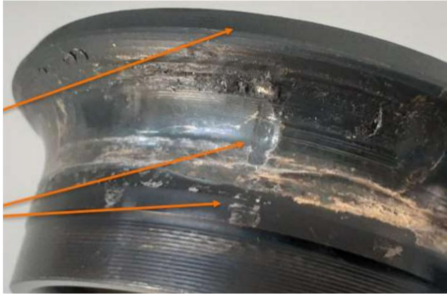
Figura 15 – Evidências de desgaste na pista interna do rolamento externo.
