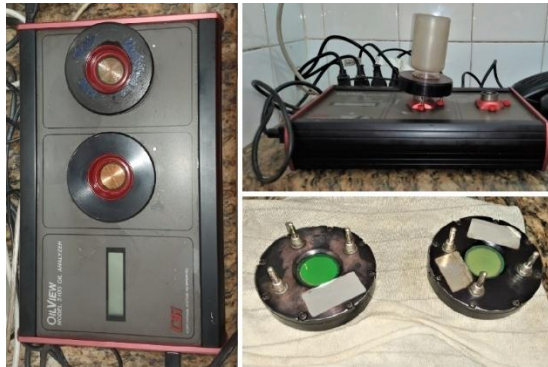
Figura 09 – Aparelho para análise de óleo - OILVIEW (Model 5100 Oil Analyzer) .
