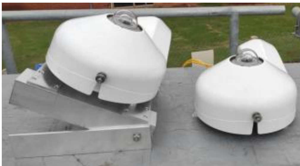
Figura 3 – Piranômetros no plano horizontal e inclinado
