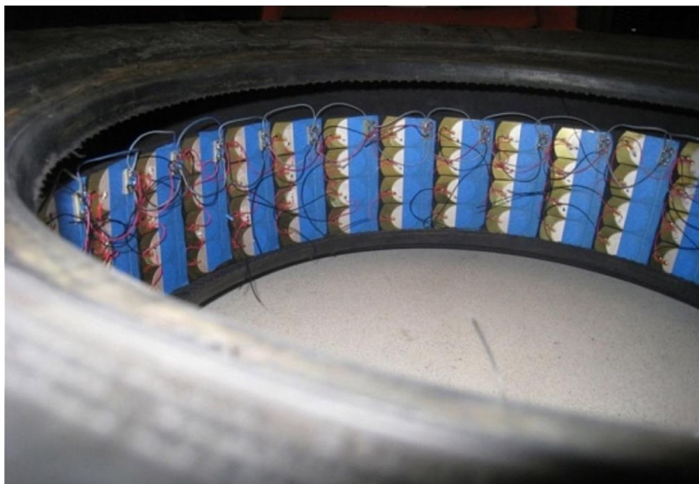
Figura 2 - Geradores piezoelétricos na superfície interna dos pneus.
