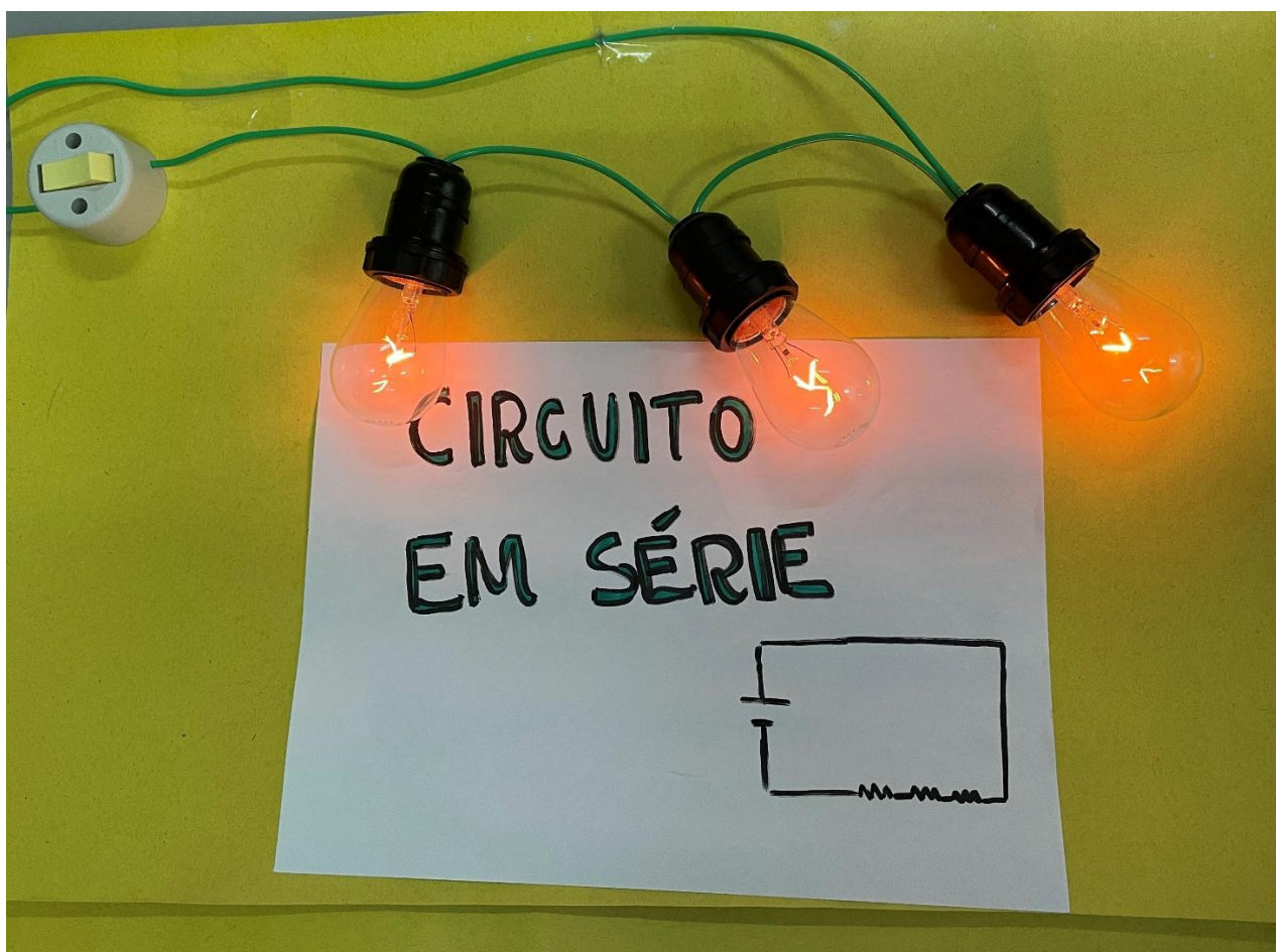
Figura 1: Montagem do circuito em série
