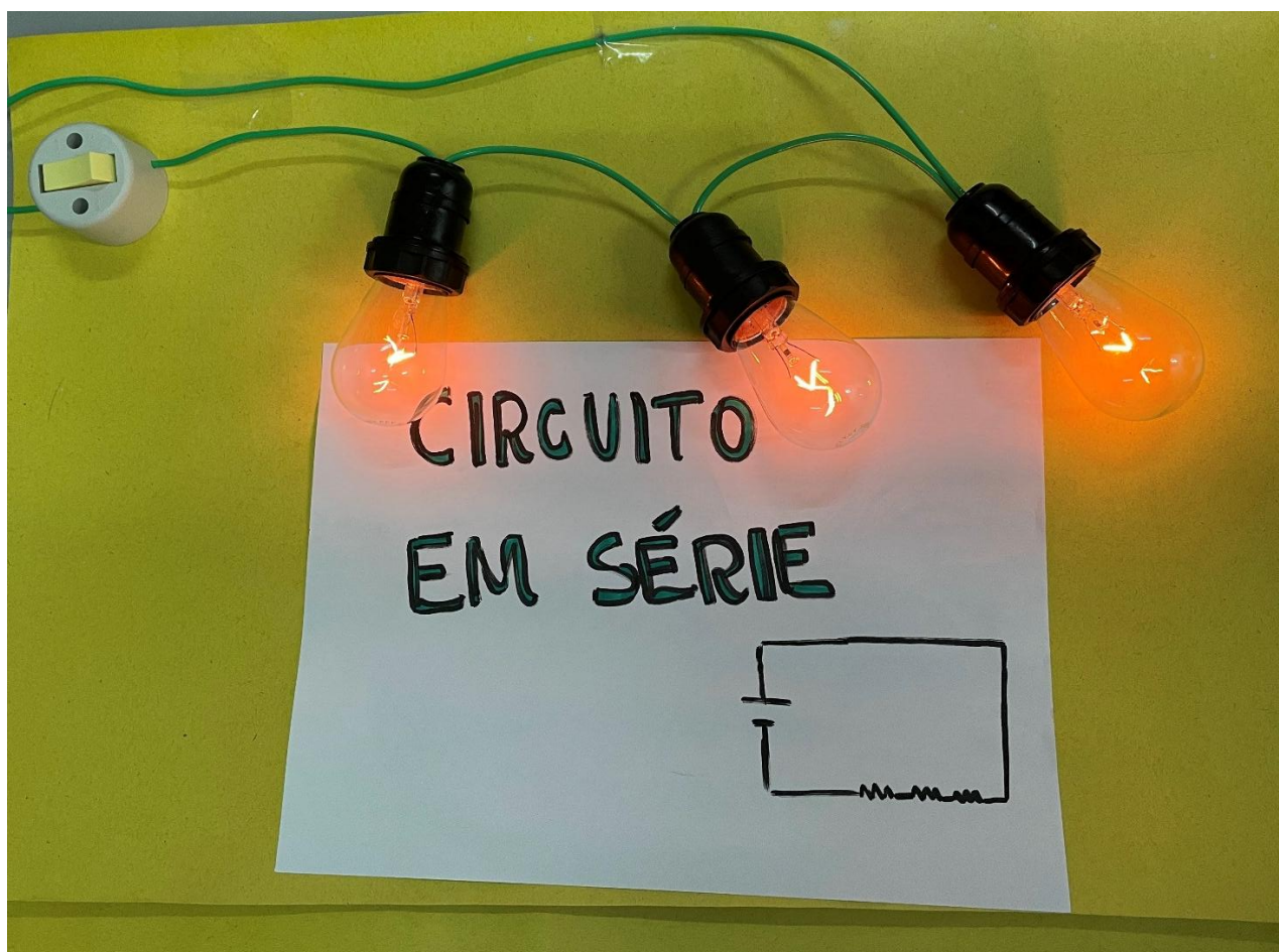
Figura 16: Montagem do circuito em série
