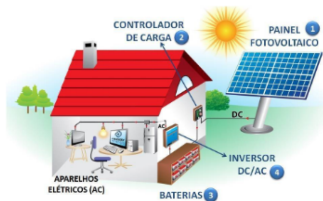
Figura 7 – Esquema de operação de um sistema fotovoltaico Off-grid.
