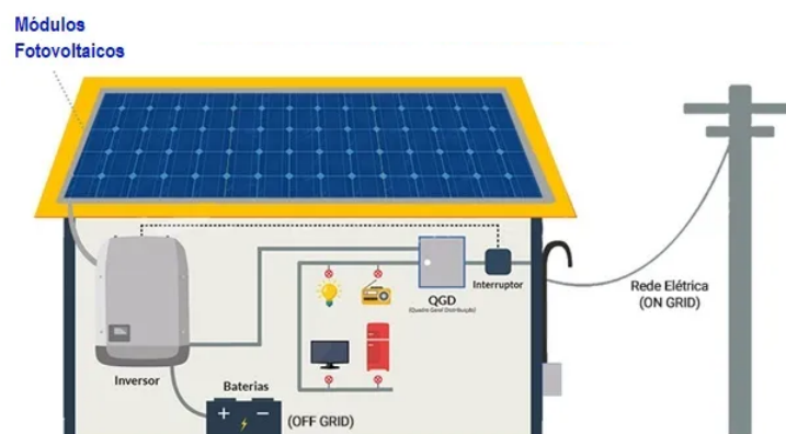
Figura 8 – Esquema de operação de um sistema fotovoltaico híbrido
