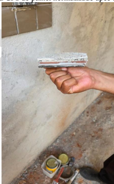
Figura 11 - Corpo de prova CP1 do painel normatizado após ensaio de aderência à tração
