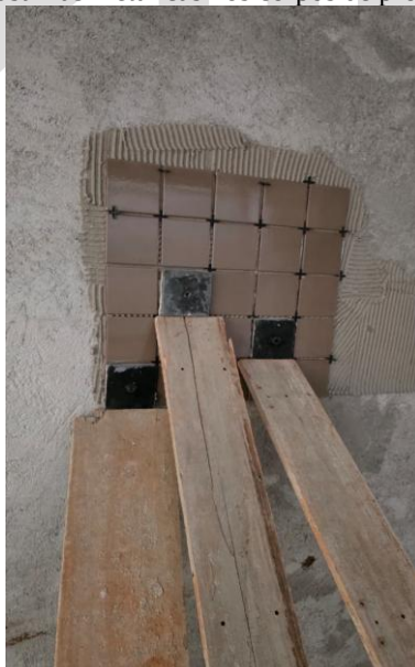
Figura 9 - Colagem das pastilhas metálicas nos corpos de prova painel não normatizado
