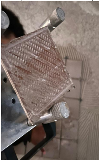
Figura 14 - Corpo de prova CP1 do painel não normatizado após ensaio de aderência à tração
