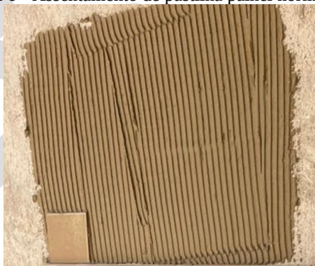
Figura 6 - Assentamento de pastilha painel normatizado
