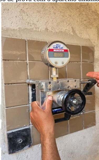
Figura 10 - Arrancamento do corpo de prova com o aparelho dinamômetro do painel normatizado CP 1
