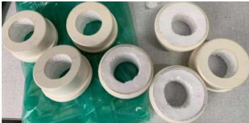
Figura 4 – Boias do sistema de monitoramento de infiltração das bacias de retenção de água e sedimentos.
