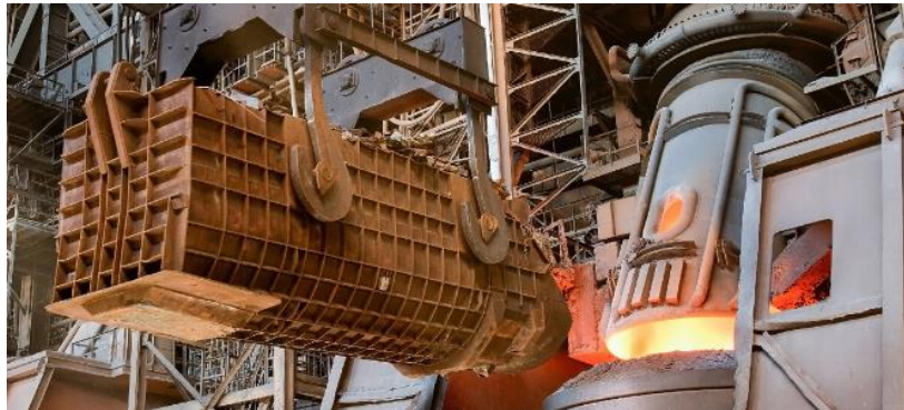
Figura 7. Carregamento de canaleta com sucatas em conversor.
