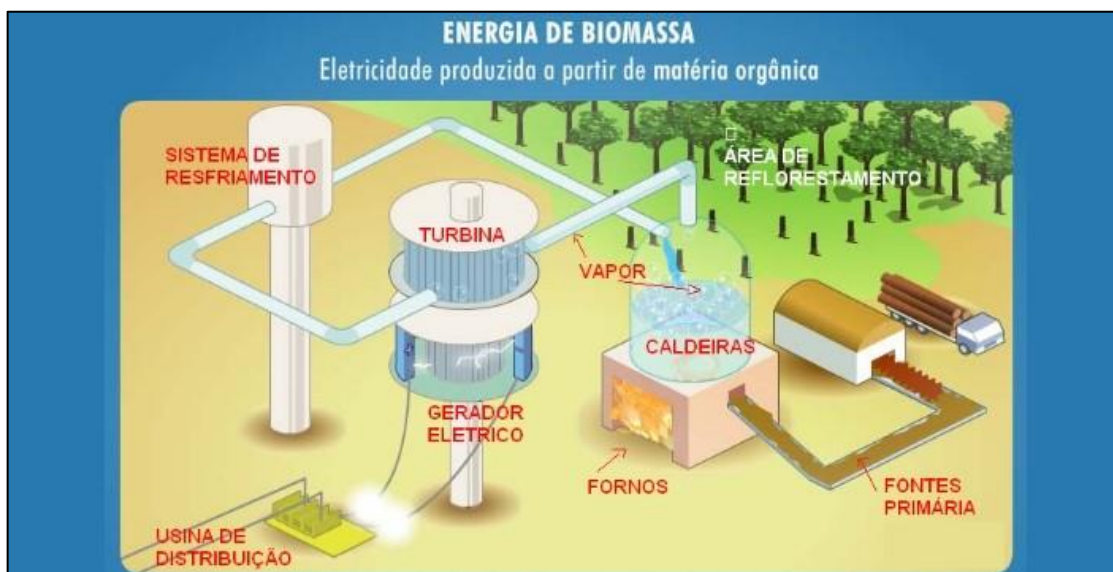
Figura 14 – Esquema de produção de energia elétrica a partir da biomassa.
