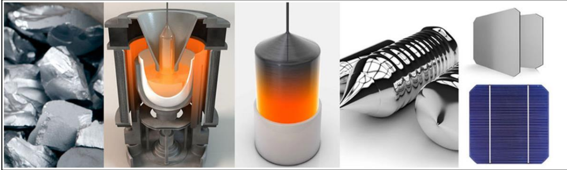
Figura 27 – Etapas de produção de uma célula fotovoltaica monocristalina.
