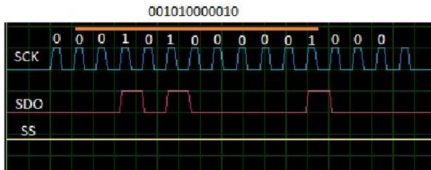
Figura 21 Sinal enviado no barramento SPI do CI MAX6675
