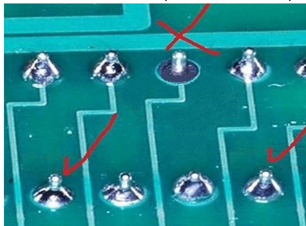
Figura 8 – Falha de solda em placa de circuito impresso real.
