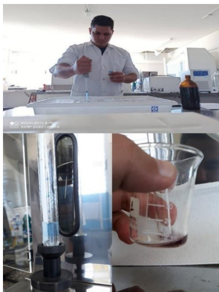
Figura 11 – Destilação das amostras digeridas
